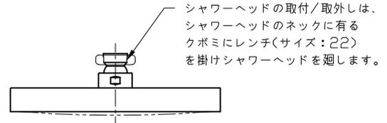
シャワーヘッドの取付/取外しは、シャワーヘッドのネックに有るクボミにレンチ(サイズ:22)を掛けシャワーヘッドを廻します。
